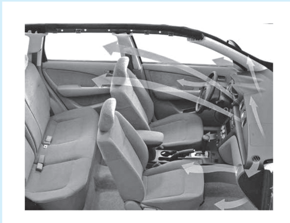
图 1-9 汽车空调的出风口位置
